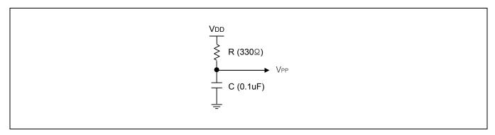
Figure 25-3 RC Delay Circuit
